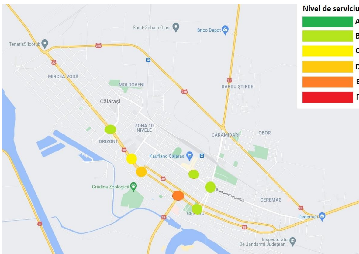
Fig. 22. Gradul de încărcare al rețelei rutiere, autovehicule - intervalul de vârf, 2021
