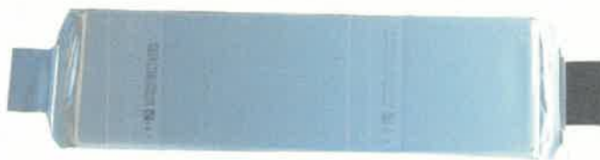
Fig.10 Celula NMC de tip „pouch”
